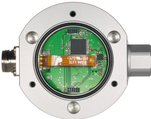
**Figure 2** l'électronique à l'intérieur du SR20-D2
