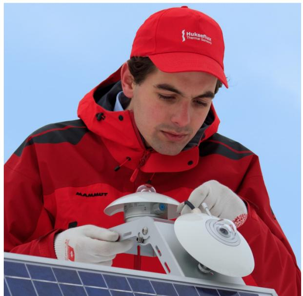
**Figure 4** SR20-D2 pyranomètre étalon secondaire avec sortie numérique pour les mesures de du GHI (rayonnement global horizontal) et du POA (dans le plan des modules)
